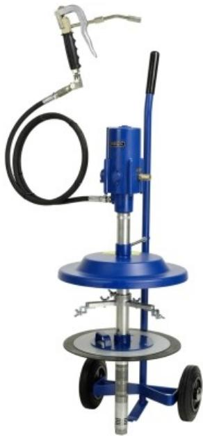
Fedtsmøresæt komplet med 50:1 fedtpumpe, monterings tilbehør, 2 m slange og 2-hjulet kærre. Pistolen er med mulighed for 100 bar ekstra tryk (500 bar i alt) og leveres med Z-drejeled. Pistolsens udløb kan adskilles på midten og monteres med udløbsslange hvis ønsket. Låget kan nemt løftes for mængdekontrol. På luftindgangssiden er pumpen monteret med trykreduktionsventil, fast indstillet på 8 bar.
